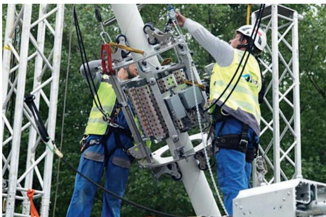
**Bild 1.** Die Mitarbeiter der Alpin Technik und Ingenieurservice GmbH beim Aufbau der magnetinduktiven Testeinheit
