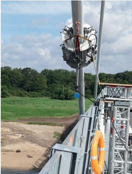
**Bild 2.** Magnetinduktive Testeinheit im Einsatz
