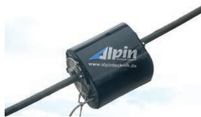
Bild 2. Befahrgerät mit mitlaufendem Strom- und Datenkabel (Fotos: Alpin Technik und Ingenieurservice)
