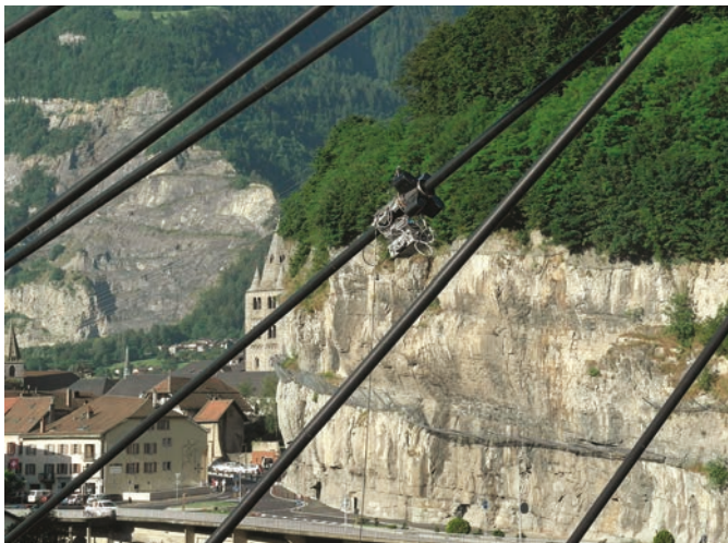
Bild 1. ATIS Seilroboter mit visuellem Panoramabildmodul
