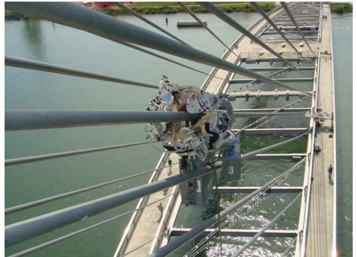
*Seilinspektion der Passerelle des deux Rives,
