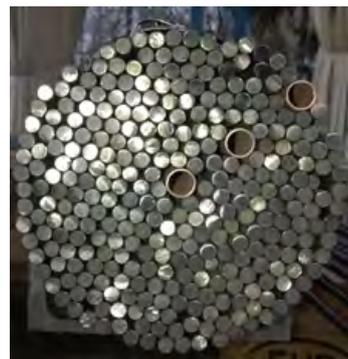
*künstlich erzeugte Fehlerstellen, die bei der Prüfung detektiert werden müssen!*
